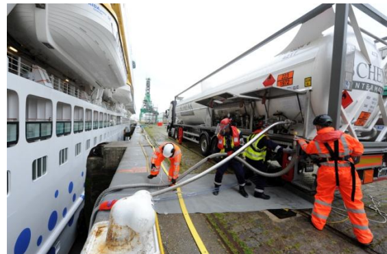
Ce 10 mai à 11 h 25 au Havre, le paquebot AIDAprima a basculé sur une production électrique alimentée par du GNL depuis le quai. C'est une première en France.
